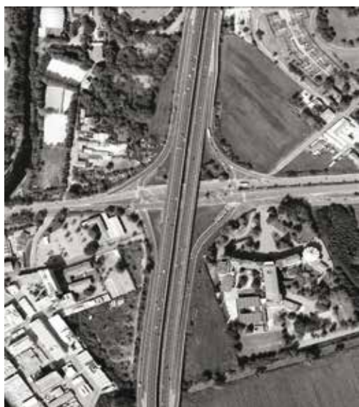
2A e 2B. Foto aeree dello svincolo prima e dopo l'intervento (rispettivamente negli anni 2007 e 2014): lo schema a diamante (2A) e il nuovo layout dei percorsi (2B)
