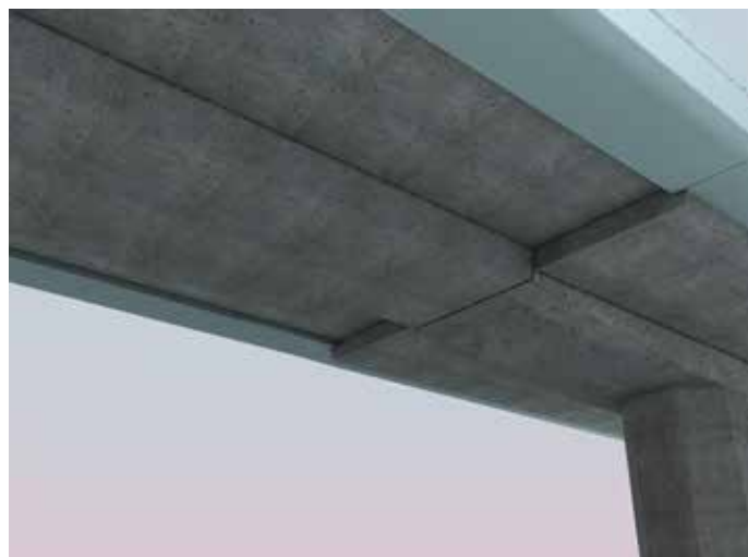
6. Un rendering dell'intradosso dell'impalcato prefabbricato
